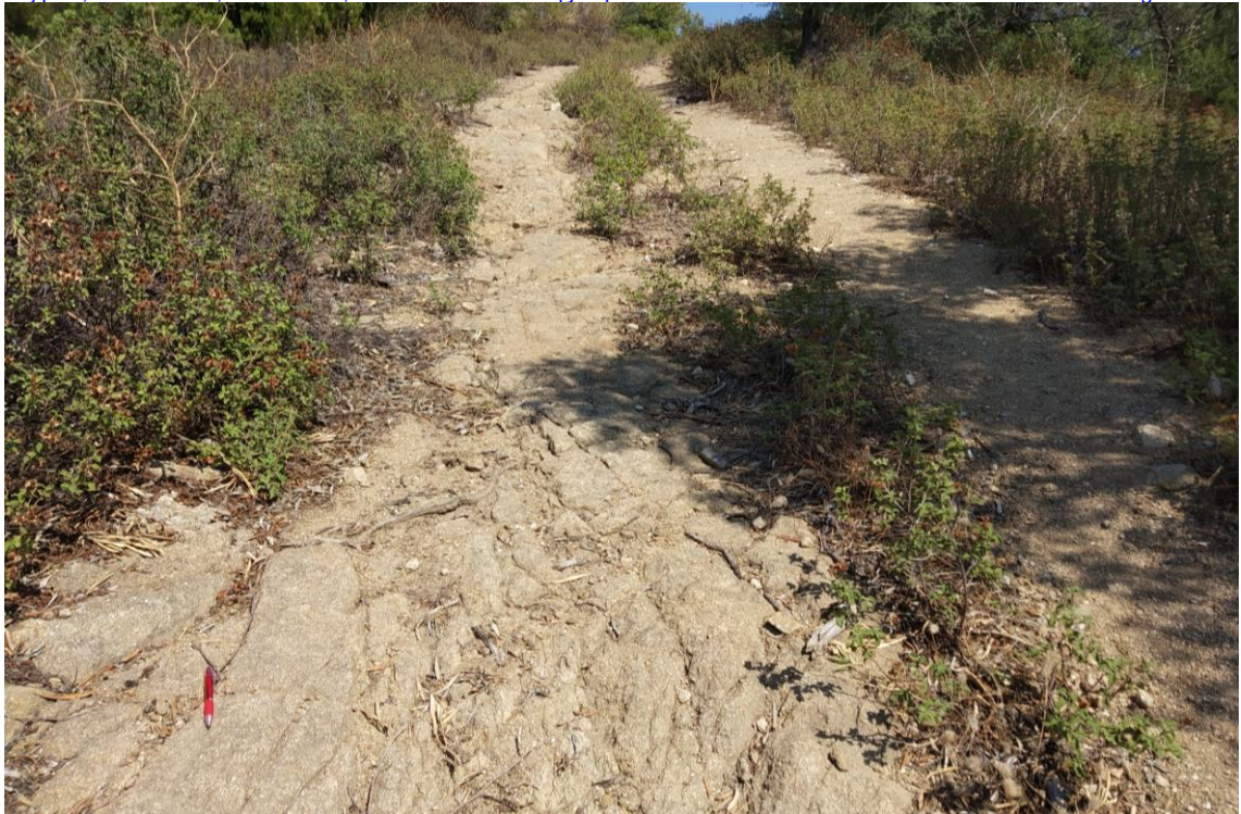
Φωτο Π.15: Βόρεια Έκταση. Άποψη της ελαφρώς αποσαθρωμένης βραχομάζας γνευσιακής σύστασης, που εντοπίζεται στο βόρειο τμήμα της εξεταζόμενης έκτασης. Η βραχομάζα εντοπίζεται μαζώδης.
