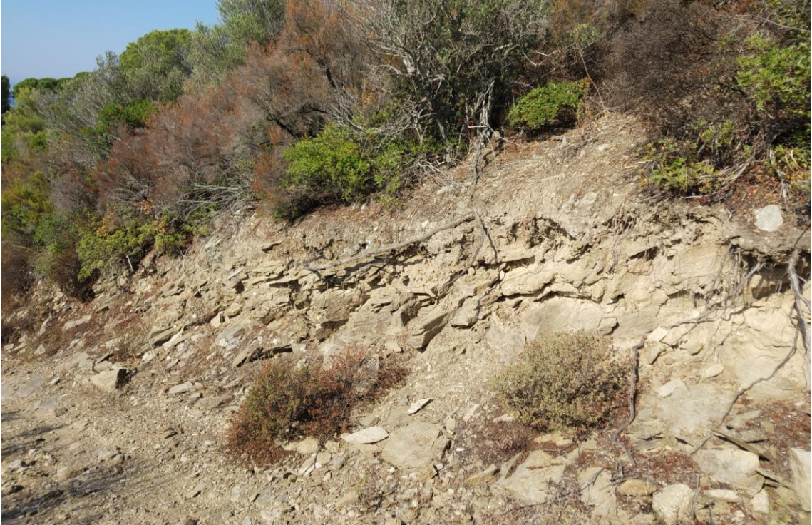
Φωτο Π.9: Νότια Έκταση . Αποψη της ελαφρώς αποσαθρωμένης βραχομάζας γνευσιακής σύστασης, που εντοπίζεται ΒΑ της εξεταζόμενης έκτασης, στον υφιστάμενο χωματόδρομο πρόσβασης. Διακρίνεται η σχιστότητα, συστήματα διακλάσεων και ο μικρού πάχους υπερκείμενος μανδύας αποσάθρωσης.
