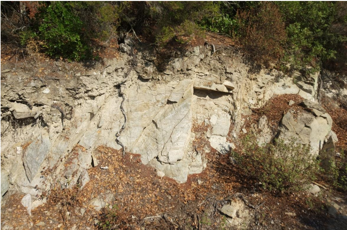
Φωτο Π.8: Νότια Έκταση . Άποψη της ελαφρώς αποσαθρωμένης βραχομάζας γνευσιακής σύστασης, που εντοπίζεται ΒΑ της εξεταζόμενης έκτασης, στον υφιστάμενο χωματόδρομο πρόσβασης. Διακρίνεται η σχιστότητα και συστήματα διακλάσεων.
