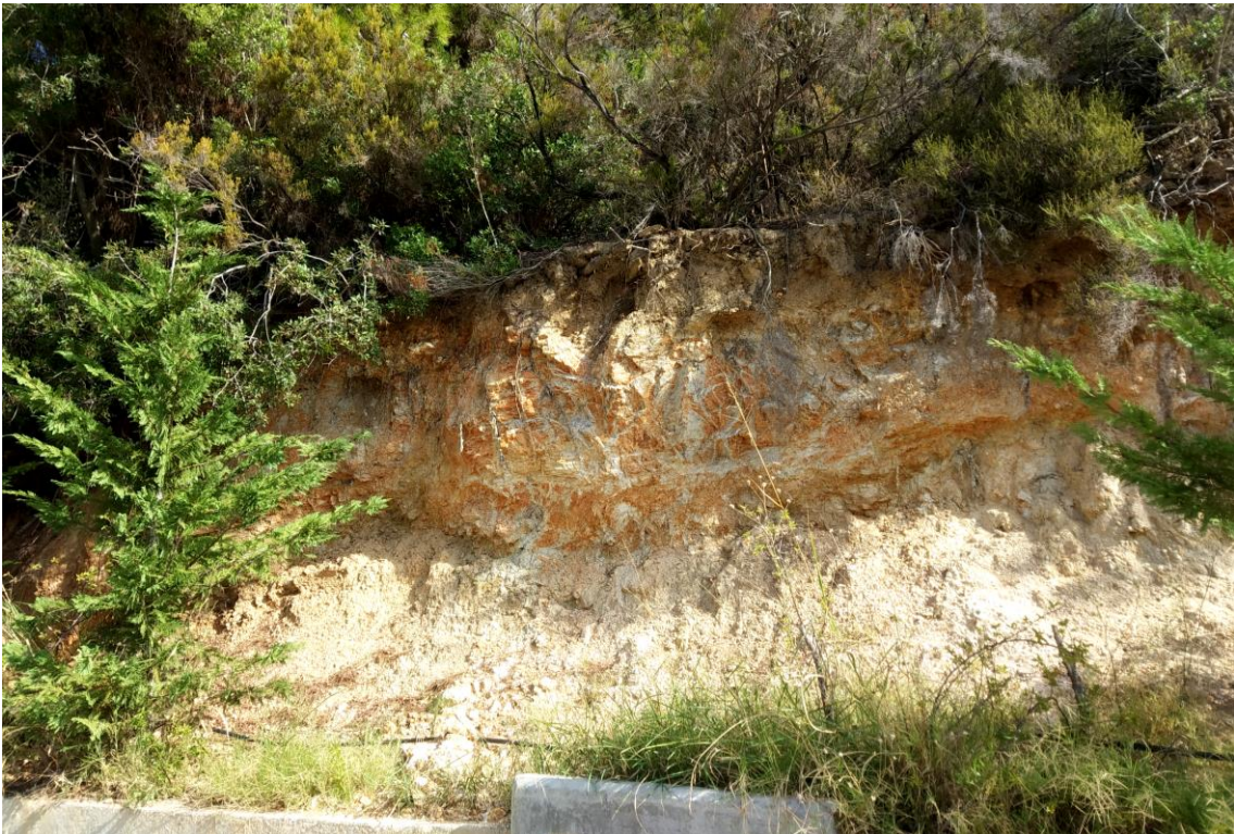
Φωτο Π.32: Βόρεια Έκταση. Άποψη του μετρίως έως ισχυρά αποσαθρωμένου βραχώδους υποβάθρου στην ανατολική πλευρά της εξεταζόμενης περιοχής.
