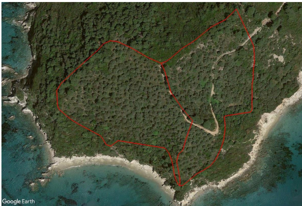
Εικόνα 11.1 (επάνω) & 11.2 (κάτω): Όρια υδρολογικών λεκανών περιοχής μελέτης (κόκκινη γραμμή). Για την ακριβή χάραξη χρησιμοποιήθηκαν οι ισοϋψείς του τοπογραφικού διαγράμματος και για την ευρύτερη περιοχή, χρησιμοποιήθηκαν οι ισοϋψείς από τον τοπογραφικό χάρτη της ΓΥΣ.
