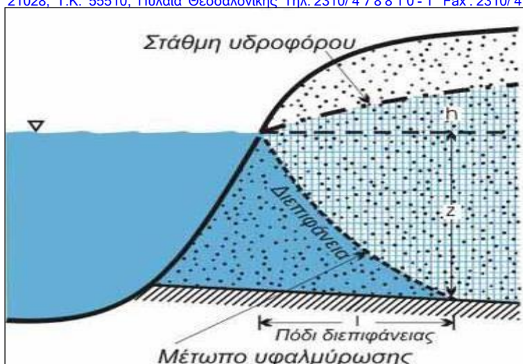
Εικόνα 12.1: Απλοποιημένο σχήμα της διεπιφάνειας γλυκού αλμυρού νερού κατά Ghyben-Herzberg. ( http://www.geo.auth.gr/763/ch5_files/p2.jpg )
