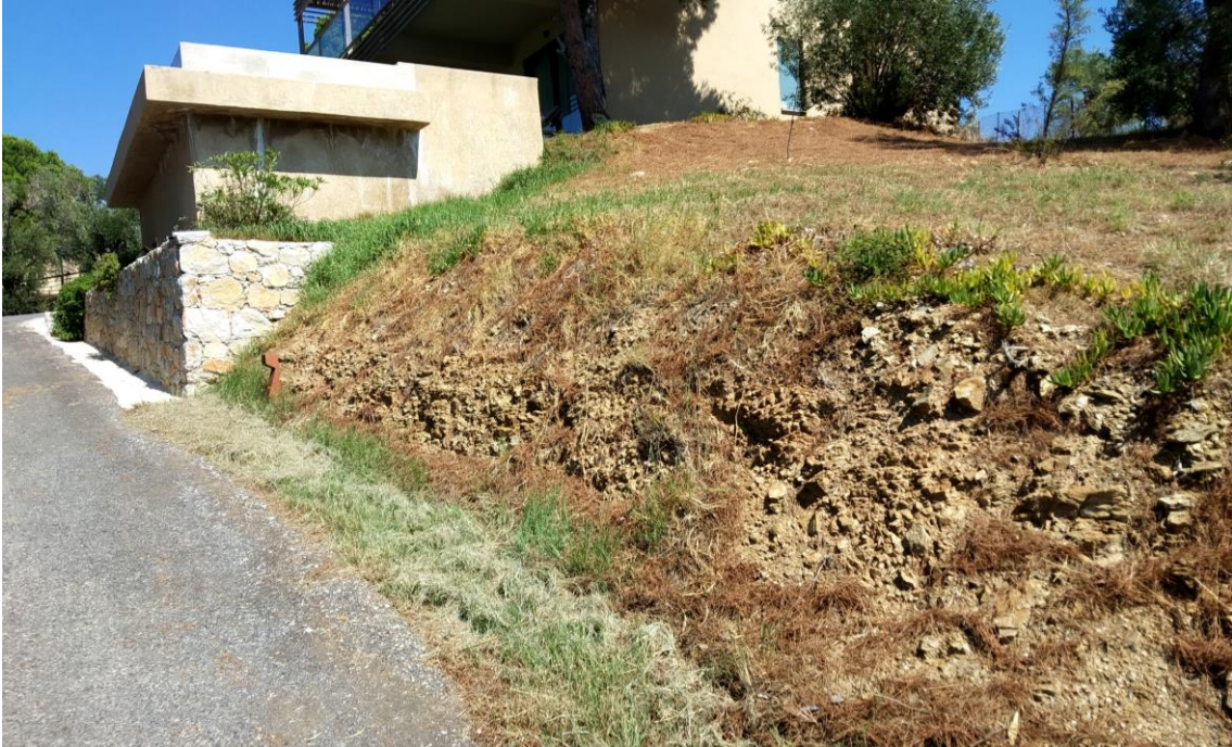
Φωτο Π.31: Βόρεια Έκταση. Άποψη του μετρίως έως ισχυρά αποσαθρωμένου βραχώδους υποβάθρου στην ανατολική πλευρά της εξεταζόμενης περιοχής.
