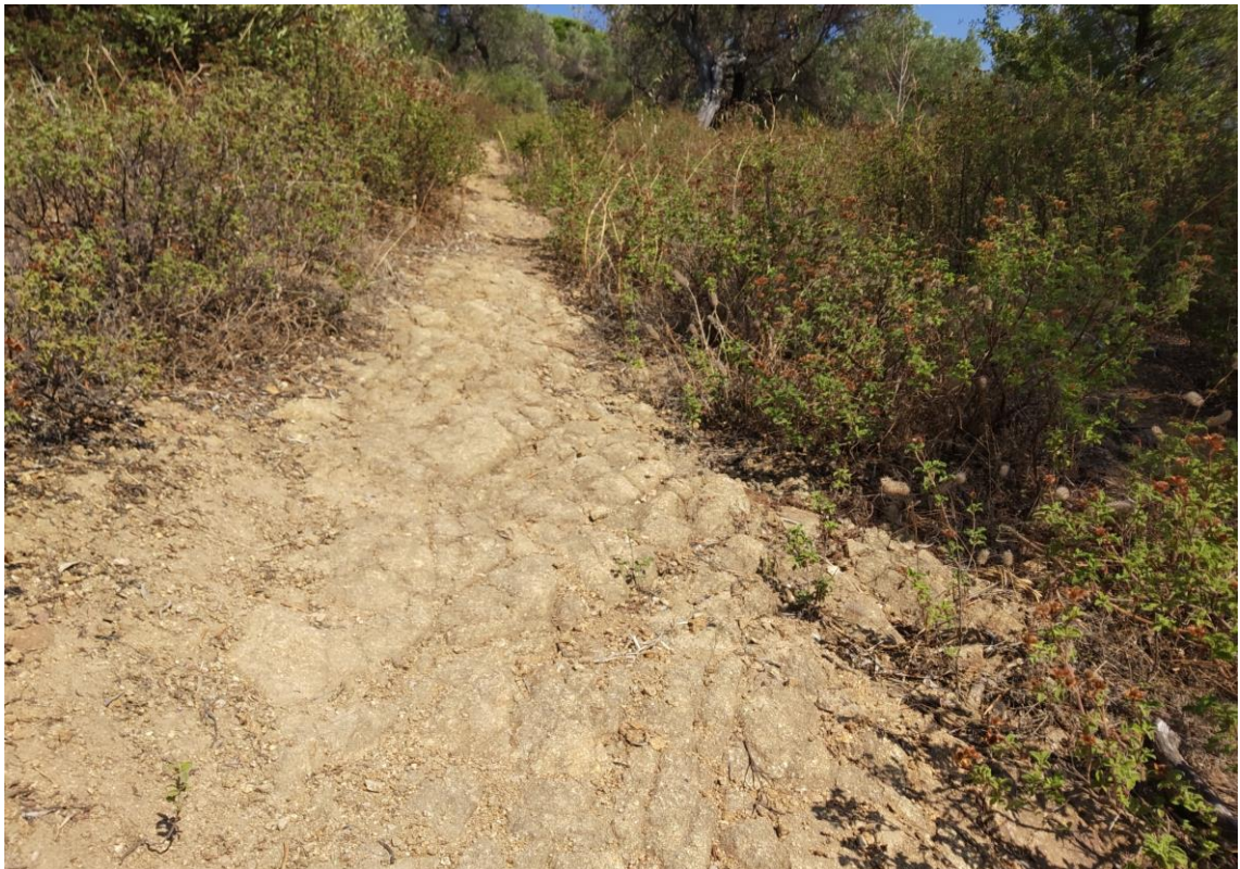
Φωτο Π.16: Βόρεια Έκταση. Άποψη της ελαφρώς αποσαθρωμένης βραχομάζας γνευσιακής σύστασης, που εντοπίζεται στο βόρειο τμήμα της εξεταζόμενης έκτασης. Η βραχομάζα εντοπίζεται μαζώδης.
