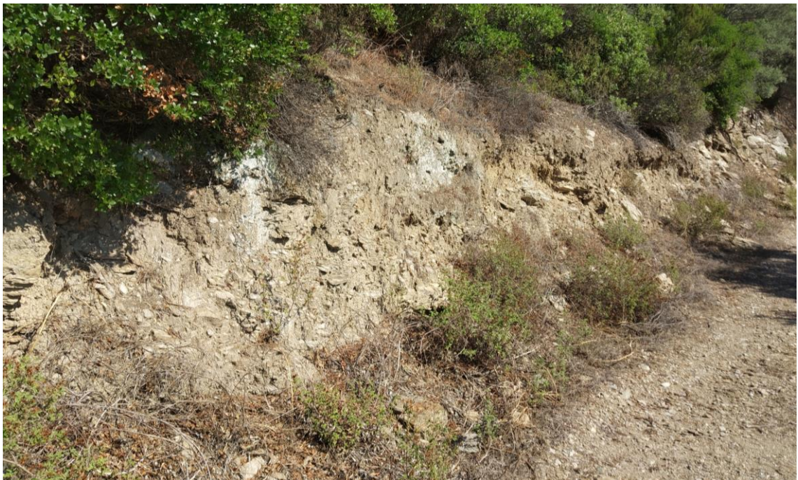
Φωτο Π.12: Νότια Έκταση. Άποψη της μετρίως αποσαθρωμένης βραχομάζας γνευσιακής σύστασης, που εντοπίζεται ΒΑ της εξεταζόμενης έκτασης, στον υφιστάμενο χωματόδρομο πρόσβασης. Διακρίνεται η σχιστότητα και ο μικρού πάχους υπερκείμενος μανδύας αποσάθρωσης.
