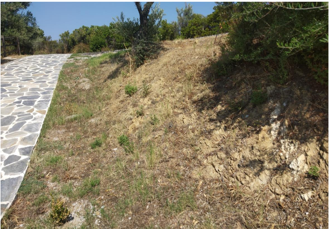
Φωτο Π.14: Βόρεια Έκταση. Άποψη της μετρίως αποσαθρωμένης βραχομάζας γνευσιακής σύστασης, που εντοπίζεται στο ανατολικό τμήμα της εξεταζόμενης έκτασης. Διακρίνεται η σχιστότητα.
