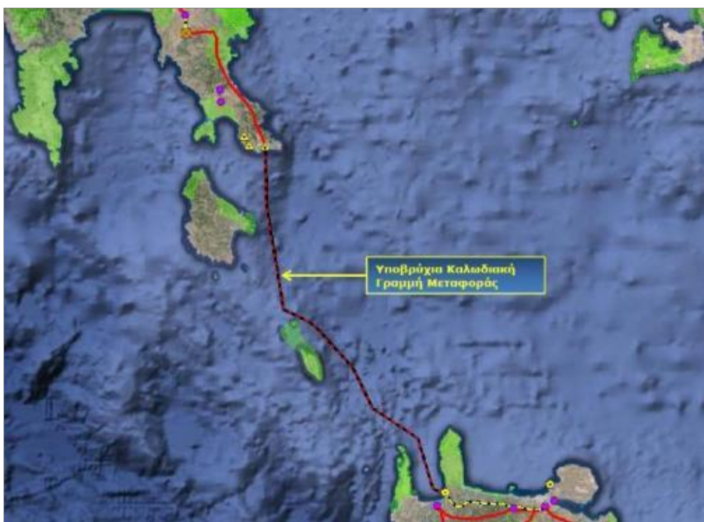
Σχήμα 6-91: Ενδεικτική θέση προσαιγιάλωσης της υποβρύχιας καλωδιακής γραμμής μεταφοράς στο πλαίσιο της διασύνδεσης της Κρήτης με την Πελοπόννησο (Πηγή: ΑΔΜΗΕ)
