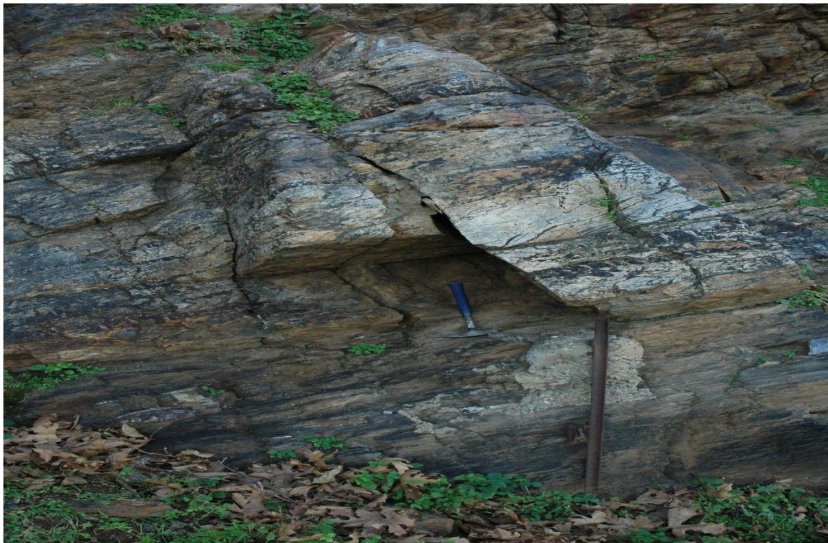
Φωτ. 65 – ΣΠ 63: Διάκλαση που διατέμνει τους Γραφικούς Φυλλίτες -Χαλαζίτες (MG).
