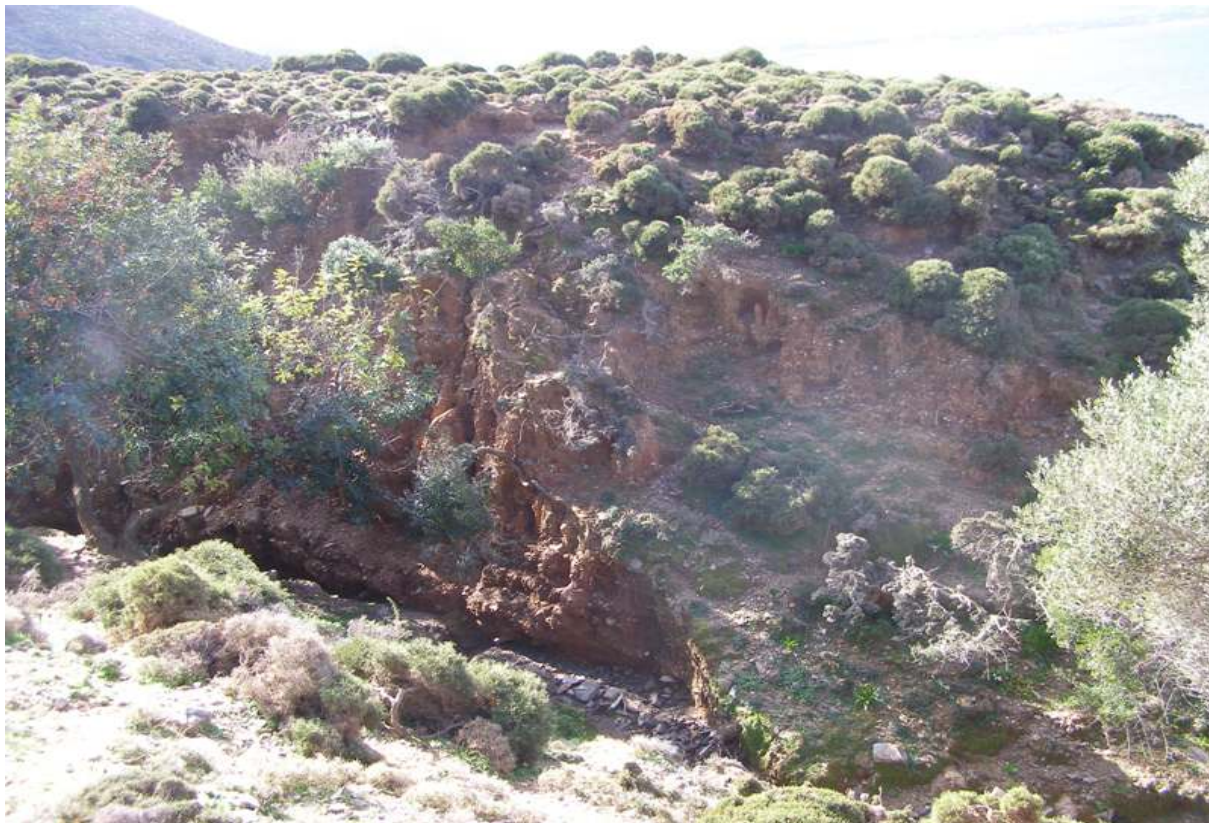
Φωτ. 89 – ΣΠ 92: Άποψη του νότιου πρανούς κοίτης υδατορέματος. Διακρίνεται το μεγάλο πάχος (έως 8 m) των πλευρικών κορημάτων (Q.sc).
