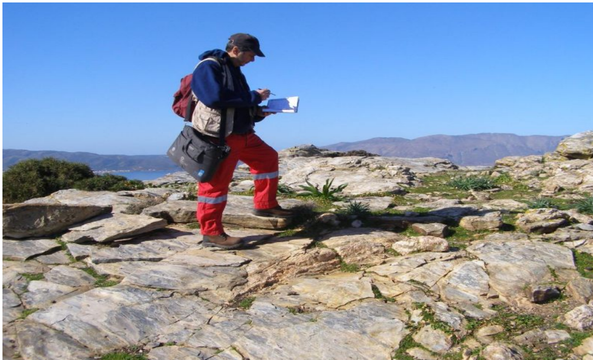
ΦΩΤ. 7 – ΣΠ 7: Συμπαγείς φυλλίτες (MQ) που διατέμνονται από πυκνό δίκτυο διακλάσεων.
