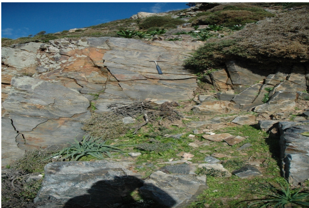
Φωτ. 78 – ΣΠ 73: Άποψη του δικτύου διακλάσεων που διατέμνει τους Φυλλίτες – Χαλαζίτες (MQ).
