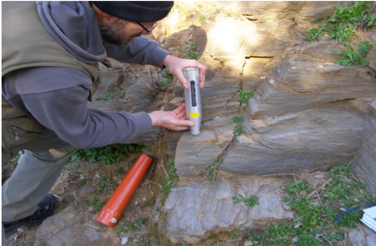
Φωτ. 9 – ΣΠ 9: Μετρήσεις τεκτονικών στοιχείων στους φυλλίτες - χαλαζίτες
