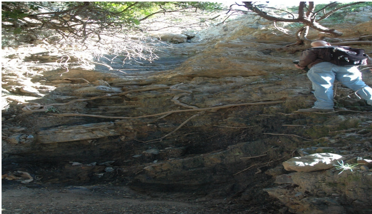
Φωτ. 77 – ΣΠ 72: Μέτρηση τεκτονικών στοιχείων σε εμφάνιση Φυλλιτών – Χαλαζιτών (MQ).
