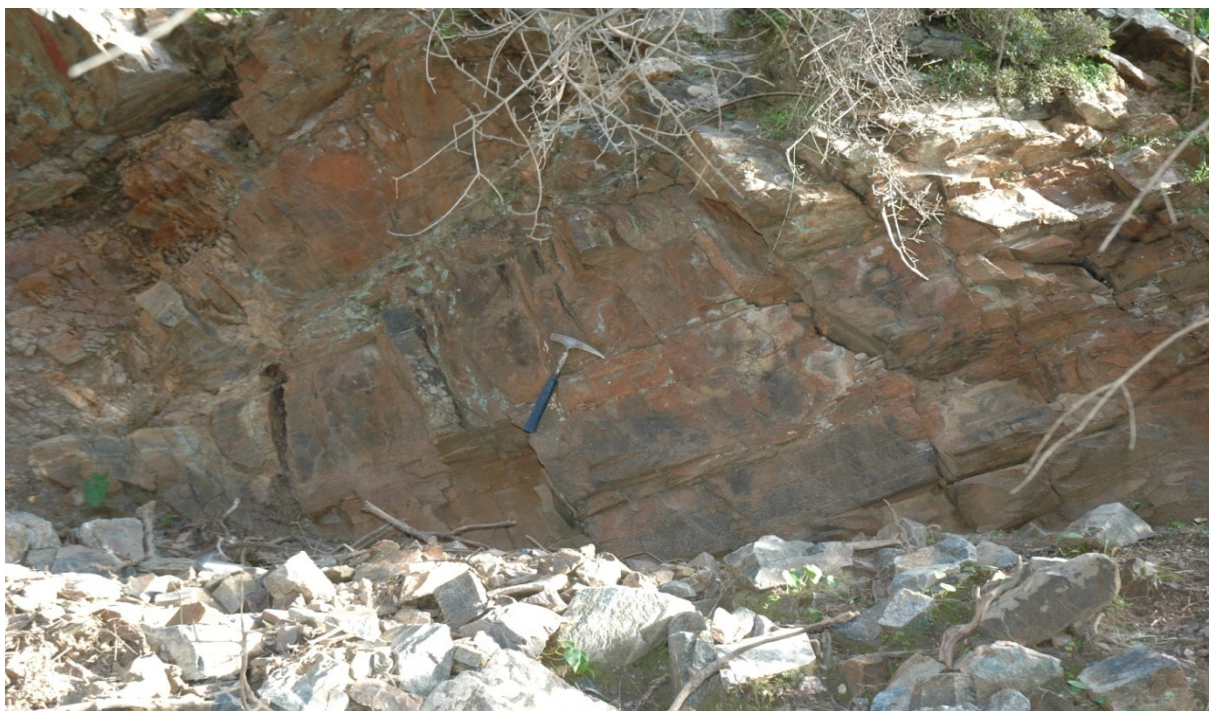
Φωτ. 80 – ΣΠ 75: Άποψη του δικτύου διακλάσεων που διατέμνει τους Φυλλίτες – Χαλαζίτες (MQ).
