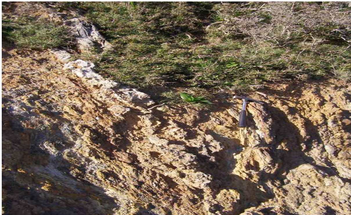
Φωτ. 24 – ΣΠ 29: Άποψη της επαφής των υπερκείμενων σχηματισμών του Νεογενούς με τους υποκείμενους φυλλίτες της Σειράς Φυλλιτών – Χαλαζιτών (MQ).
