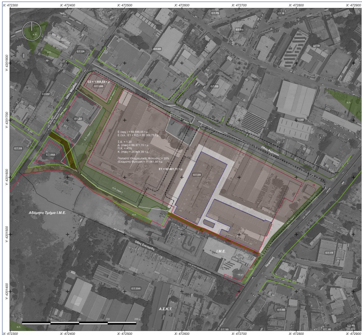
ΕΙΚΟΝΑ 6.6: Σενάριο III: Ε.Σ.Χ.Α.Σ.Ε. για την ανάπτυξη συγκροτήματος γραφείων με σ.δ. 1,2 και τροποποίηση του ρυμοτομικού σχεδίου
